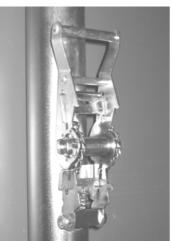
Per togliere o diminuire la tensione del nastro, tenere premuto la lamella dell'argano verso il basso e spostare la leva verso l'alto come nel disegno. Poi afferrare il nastro e tirare per sfilarlo.
